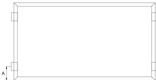
Figure 8 : Montage petits coté avec étriers - Rail perpendiculaire au petit côté.
