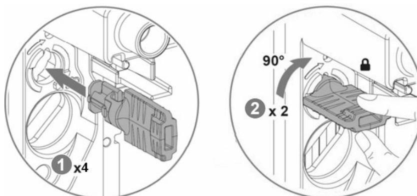
**Figure 7. Montage de l'UPM sur gaines techniques**
