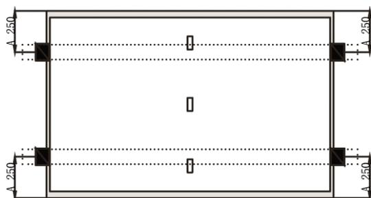
Figure : 10 : Montage avec 4 étriers sur le petit côté. Profilé en acier perpendiculaire au côté court. Etrier : Largeur = 40-50mm, Hauteur = 30mm. Distance A = 250±20mm. Charge maximale : Avant ≤ 4800 Pa, Arrière ≤ 1200 Pa
