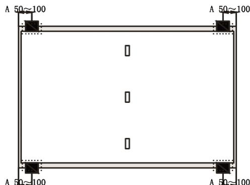
Figure 8 : Montage avec 4 étriers sur le long côté. Profilé en acier dans les angles. Etrier : Largeur = 40-50mm, Hauteur = 30mm. Distance A = 50-100mm. Charge maximale : Avant  $\leq 1800$  Pa, Arrière  $\leq 1800$  Pa
