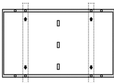
Figure 4 : Montage avec fixation sur le côté long avec les 4 trous intérieurs (990mm) pour le montage des boulons. Profilé en acier perpendiculaire au côté long. Charge maximale : Avant  $\leq 5400$  Pa ; Arrière  $\leq 2400$  Pa
