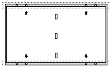
Figure 3 : Montage avec fixation sur le côté long avec les 4 trous intérieurs (990mm) pour le montage des boulons. Profilé en acier parallèle au côté long. Charge maximale : Avant  $\leq 2400$  Pa ; Arrière  $\leq 2400$  Pa
