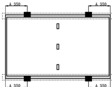
Figure 6 : Montage avec 4 étriers sur le long côté. Profilé en acier parallèle au côté long. Etrier : Largeur = 40-50mm, Hauteur = 30/35mm. Distance A =  $350 \pm 20$ mm. Charge maximale : Avant  $\leq 2400$  Pa, Arrière  $\leq 2400$  Pa
