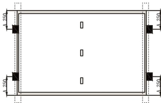
Figure : 9 : Montage avec 4 étriers sur le petit côté. Profilé en acier parallèle au côté court. Etrier : Largeur = 40-50mm, Hauteur = 30mm. Distance A = 250±20mm. Charge maximale : Avant ≤ 1200 Pa, Arrière ≤ 1200 Pa
