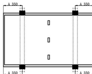
Figure 7 : Montage avec 4 étriers sur le long côté. Profilé en acier perpendiculaire au côté long. Etrier : Largeur = 40-50mm, Hauteur = 30/35mm. Distance A =  $350 \pm 20$ mm. Charge maximale : Avant  $\leq 5400$  Pa, Arrière  $\leq 2400$  Pa
