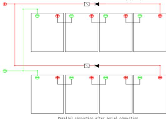
Figure 1 : Raccordement en parallèle après raccordement en série
