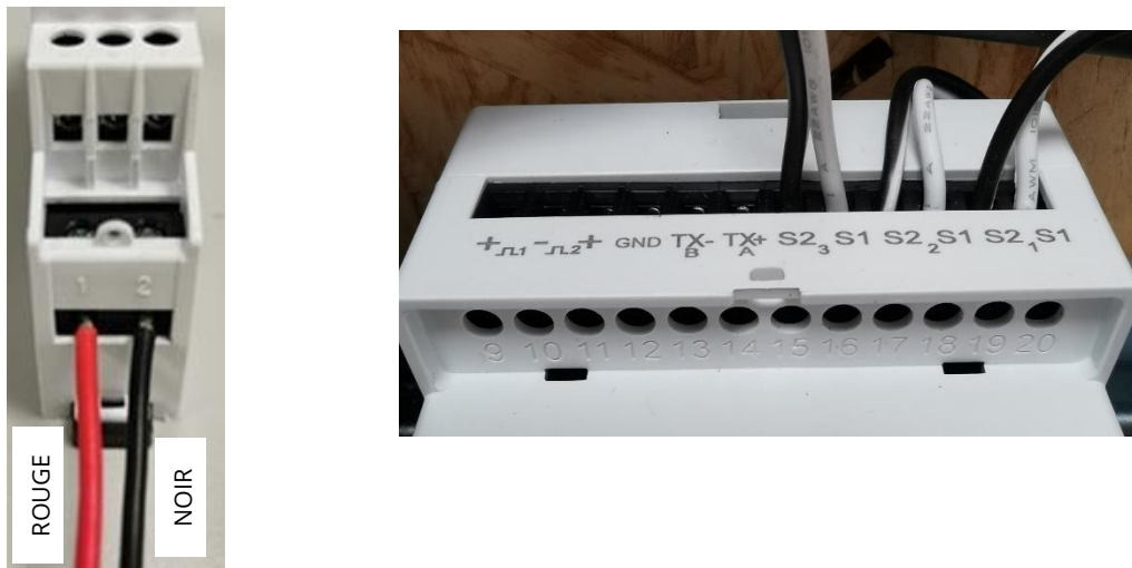
Figure 10. Branchement du ou des transformateurs de courant sur le compteur monophasé (Image gauche) ou sur le compteur triphasé (Image droite)
