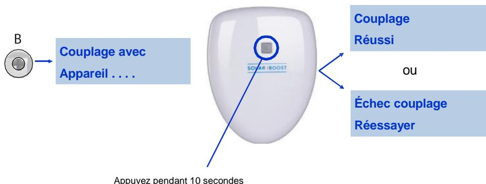
**IMPORTANT!** Ne pas appuyer sur le bouton de l'émetteur, sauf lors de l'exécution du processus de jumelage. S'il est appuyé pendant plus d'une seconde, le jumelage pourrait être perdu et l'écran affichera le message 'Signal Perdu' (voir section Dépannage). Pour corriger ou réinitialiser l'émetteur, enlevez et réadaptez les piles ou utilisez la procédure ci-dessus pour réinitialiser l'appairage.
